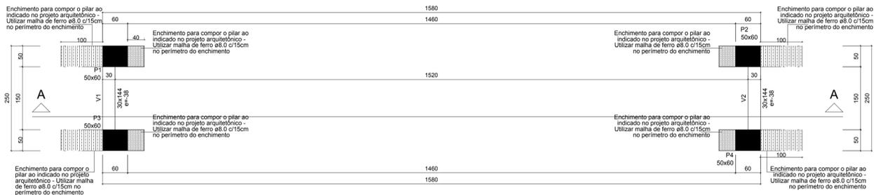
Forma do pavimento Cobertura (Nível 755) escala 1:50
